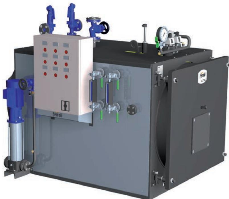
Generatore di vapore saturo a media pressione ad inversione di fiamma, monoblocco in acciaio, a combustione pressurizzata ed elevata efficienza energetica. Predisposto per funzionare in abbinamento ad un bruciatore ad aria soffiata a combustibile liquido o gassoso. Focolare ad inversione di fiamma e camera di combustione con fondo bagnato e dimensionata in modo tale da assicurare bassi carichi termici.
